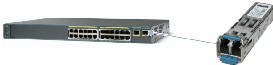
Abb. 2-3: Beispiel für eine SFP-Schnittstelle mit einem passenden Modul
