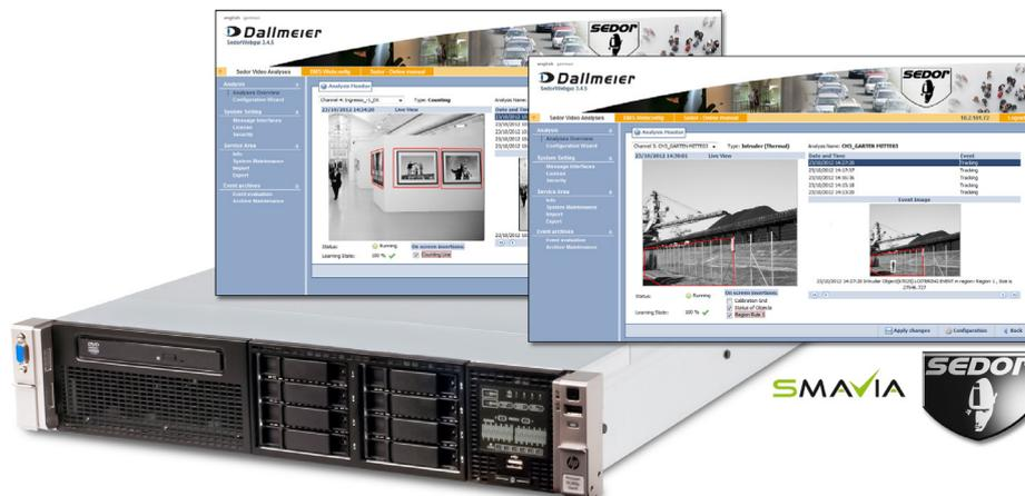
Der **DVS 2500** ist eine SEDOR® Videoanalyse Server Appliance für die Analyse von bis zu 24 IP-basierten Video-Streams. Die dedizierte Server Software **DVS Analysis Server** ist ab Werk installiert und wird über die integrierte **SEDOR® WebGUI** via Ethernet mit einem Browser konfiguriert. In Verbindung mit den optionalen Lizenzen für die verschiedenen **SEDOR® Analyse-Applikationen** können bis zu 24 Kanäle bedarfsgerecht für die Videoanalyse genutzt werden.
