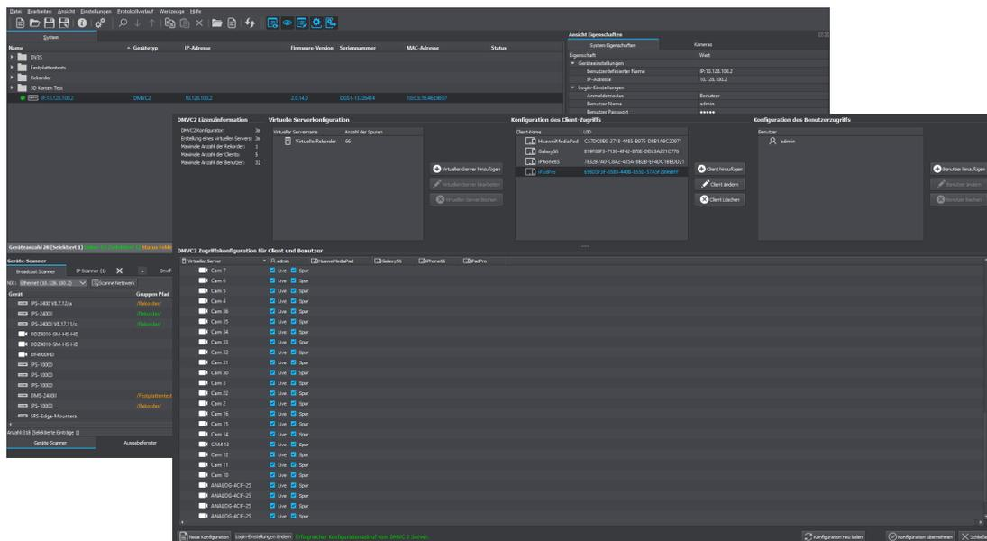
DMVC 2 è un software server per il collegamento di sistemi di registrazione Dallmeier ad Internet. Con DMVC 2, è possibile accedere all'intera rete video locale tramite un comune indirizzo IP esterno. Utilizzando l'applicazione per smartphone DMVC 2 è possibile accedere a tutte le immagini live e a quelle registrate tramite la rete mobile o WiFi. Una speciale transcodifica ottimizza il video per una visualizzazione ideale sul dispositivo mobile ed al contempo ne garantisce un elevato frame rate.
