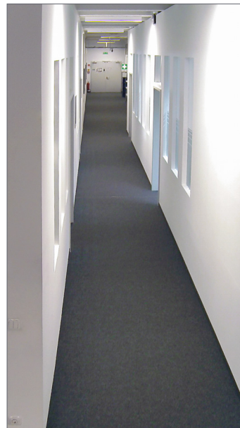
Auflösung Full HD, Sensor-Seitenverhältnis 9:16, physische Kameradrehung um 90°, clientseitige Bild-drehung um 90°
