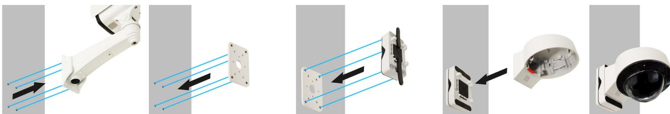
Der Domera® Wall Bracket Adapter (IR Box) erlaubt die Montage des multifunktionalen Domera® Wall Bracket auf den Bohrlöchern des Wandarms einer IR-Kamera der Serien DF4000HD-DN/IR und DF5000HD-DN/IR. Damit können ältere IR-Box-Kameras einfach und effizient durch die neuesten Modelle aus den Domera® RDF6000DN und RDF5000DN Serien ersetzt werden.
