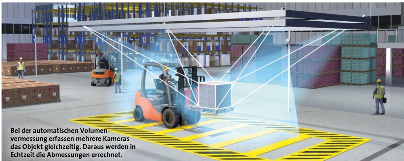
Bei der automatischen Volumenermessung erfassen mehrere Kameras das Objekt gleichzeitig. Daraus werden in Echtzeit die Abmessungen errechnet.
