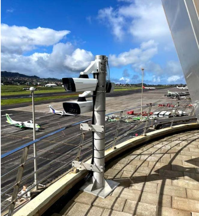
*Dank der patentierten Multifocal-Sensortechnologie können die Panomera® Kameras auch weite Entfernungen mit hoher Auflösung abdecken.*
