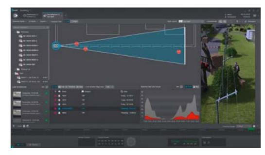
Uno de muchos ejemplos de análisis de vídeo moderno: La clasificación de objetos basada en IA sólo transmite aquellas alarmas que realmente requieren la verificación humana.
