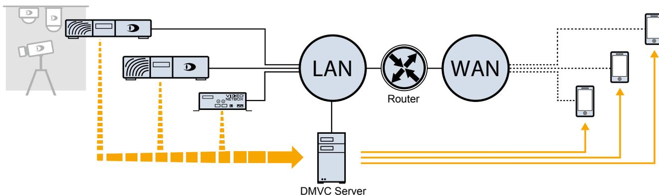
Die **DMVC Server** Software kann auf einem Office-PC mit aktueller Standard-Hardware installiert und betrieben werden. Die integrierte grafische Benutzeroberfläche erlaubt eine schnelle und einfache Konfiguration. Neben der integrierten Benutzerverwaltung mit Berechtigungsmanagement garantiert die Nutzung der Funktion Client-Whitelist einen personalisierten und gegen Missbrauch geschützten Zugriff auf die angebotenen Dallmeier Aufzeichnungssysteme.
